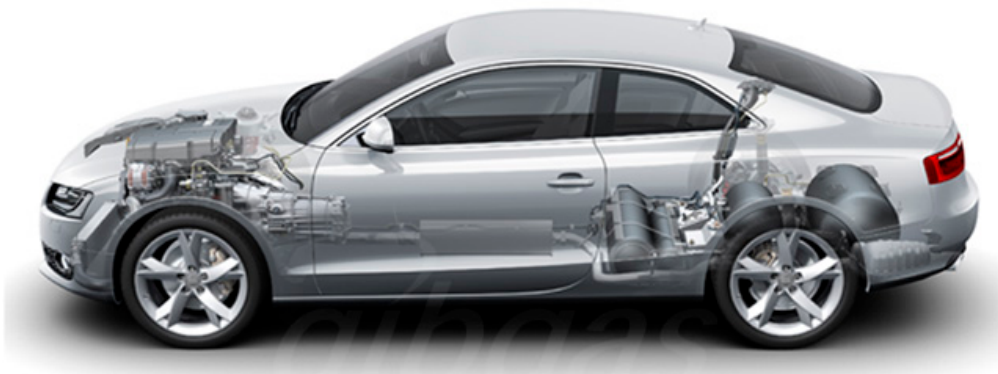
Slika 5: Postavitev CNG jeklenk v karoserijo vozila
